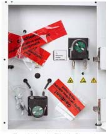
图84 运输过程中管子的保护
