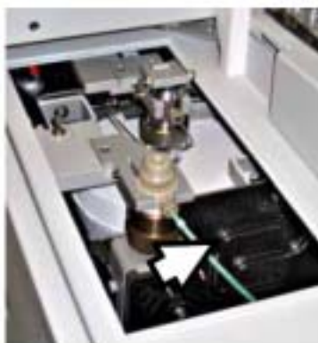
图17 旋管冷凝器（上面板打开）
