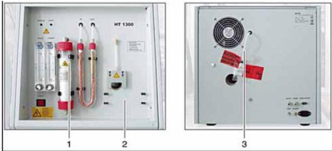
图 118 仪器运输时保护管路末端
