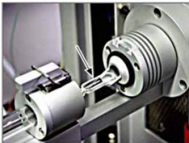
图 105 燃烧炉进样口打开状态的固体测定模块（箭头指的是燃烧舟）
