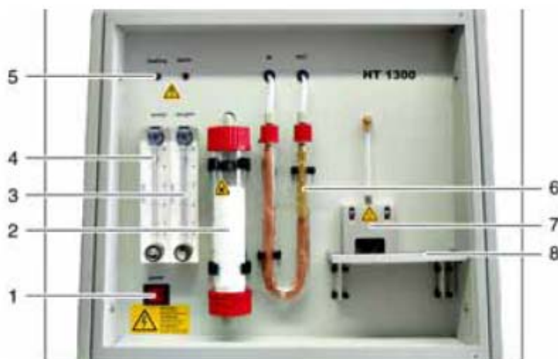
图 109 HSC1300 固体测定模块前视图
