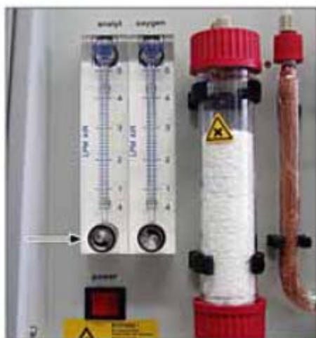
图 123 调节吸入流量的转子流量计的阀门（箭头所示）
