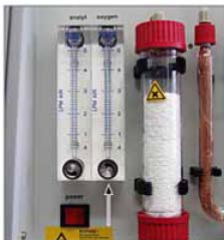
图 122 调节氧气流量的转子流量计的阀门（箭头所示）
