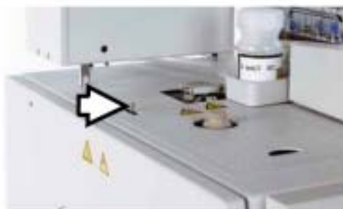
图7 无进样垫的进样口的手动转换开关
