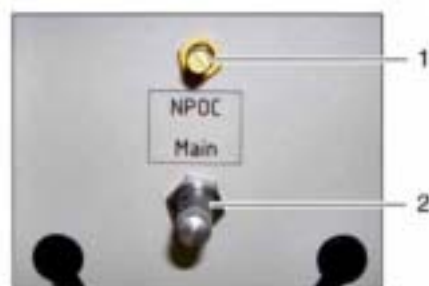
图10 IL530 TOC-TN的针阀
