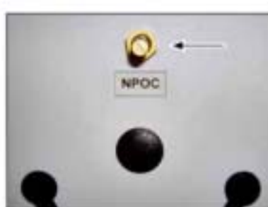
图11 IL550 TOC-TN的针阀
