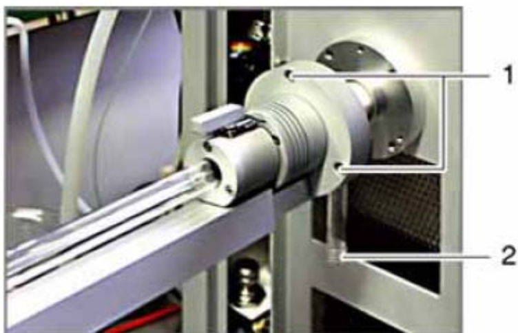
图 103 安装固体测定模块
